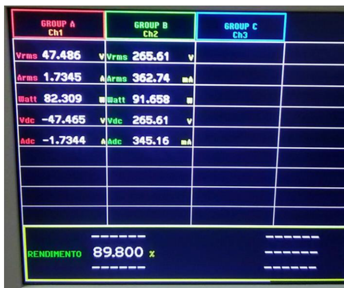
Figura 154 – Imagem com dados mostrados na tela do analisador de energia Tektronix modelo PA4000
