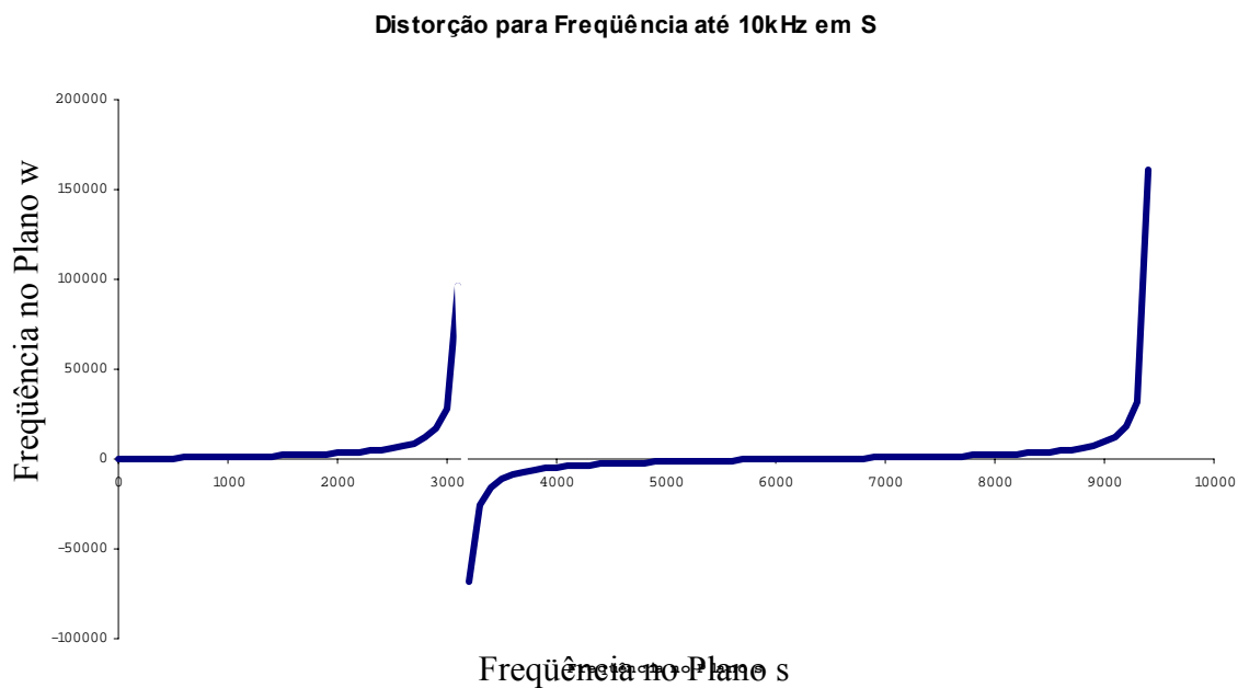
Figura 4-21 Distorção para frequência no plano s até 10kHz, com T_a=1\text{ms} .
