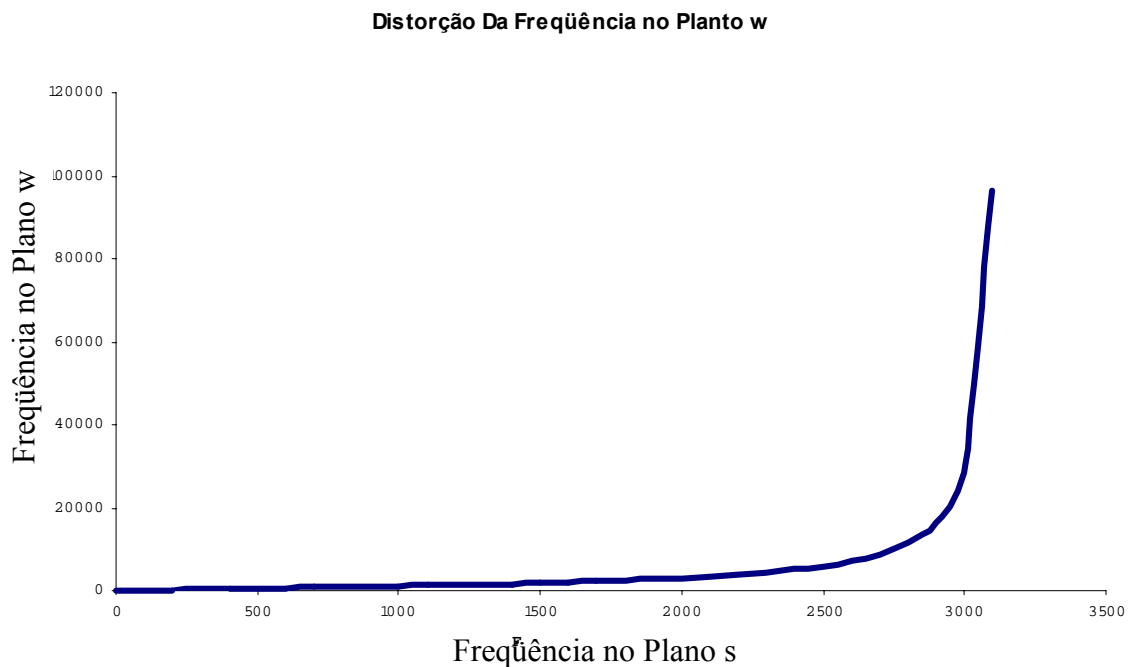
Figura 4-19 Distorção na frequência devido ao mapeamento usando a transformação bilinear, com Ta=1\text{ms} .
