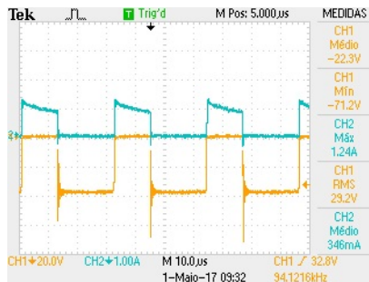
Figura 3.33 – Resultados experimentais do conversor Buck-Boost operando em modo Boost - tensão e corrente no diodo.
