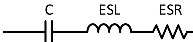
Figura 4 - Modelo real de um capacitor
