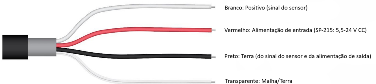
Figura 17 – Diagrama de conexões - piranômetro SP-215.
