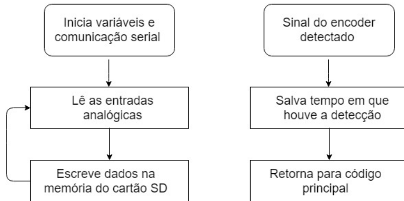
Figura 5.25. Diagrama de blocos da programação do Arduino para as medições com módulo de cartão SD.
