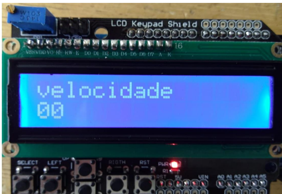
Figura H-1. Display LCD 16x2 para apresentar velocidade do kart para o piloto.
