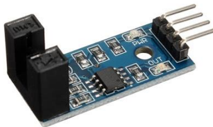
Figura 3.4. Módulo encoder MOCH22A da Junye®.
