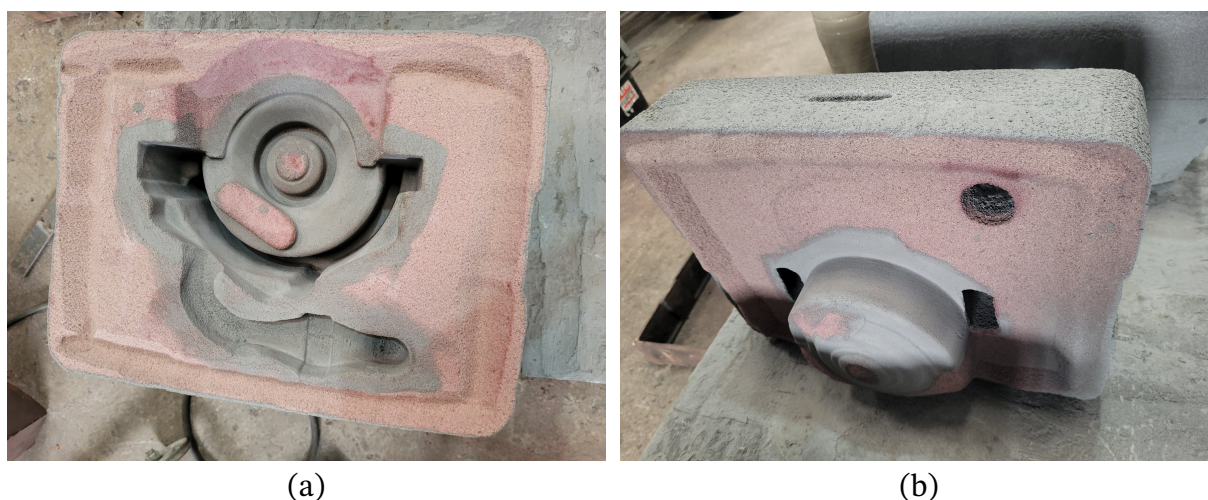
Figura 33: Molde bipartido de areia: parte inferior (a) e parte superior (b).
