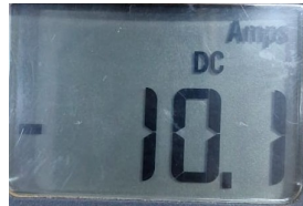
Figura 67 – Medição da corrente de saída do APM.
