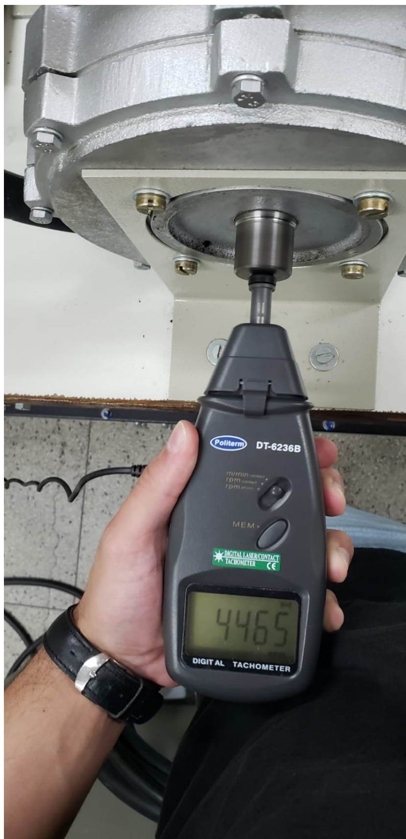
Figura 80 – Leitura realizada com tacômetro diretamente no rotor.
