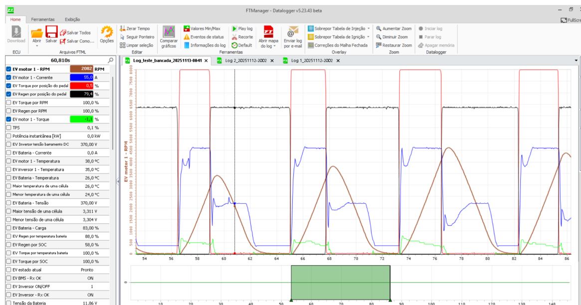
Figura 98 – Registro de dados da operação, ilustrando a transição do torque de tração para o freio regenerativo após a desativação do comando do acelerador.
