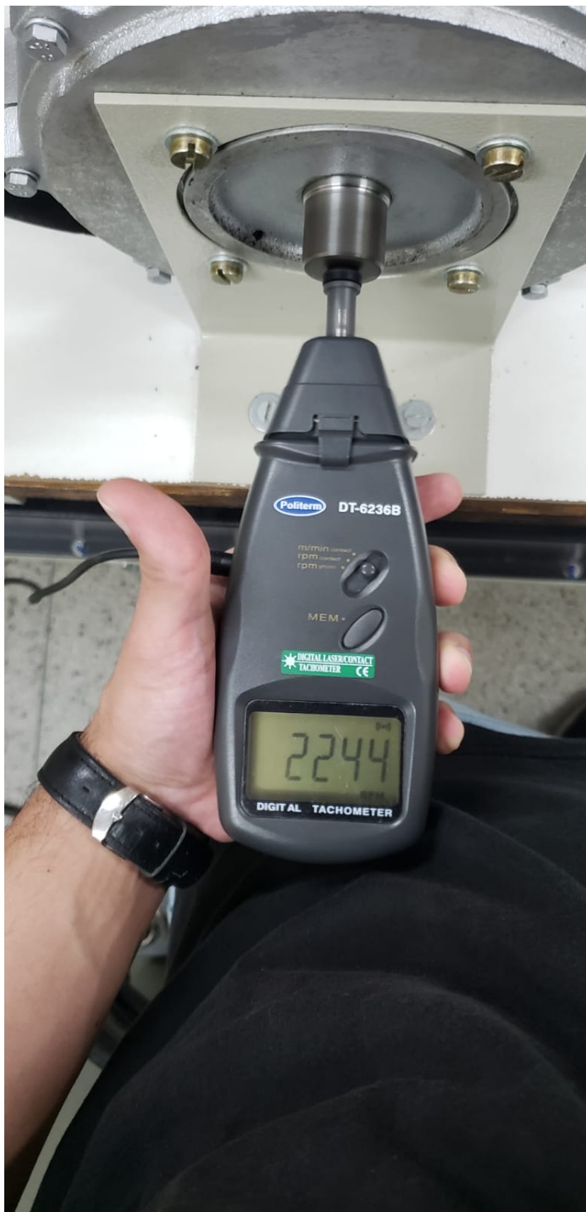
Figura 83 – Leitura realizada com tacômetro diretamente no rotor.
