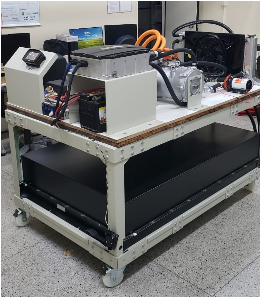
Figura 77 – Montagem final da bancada de testes.
