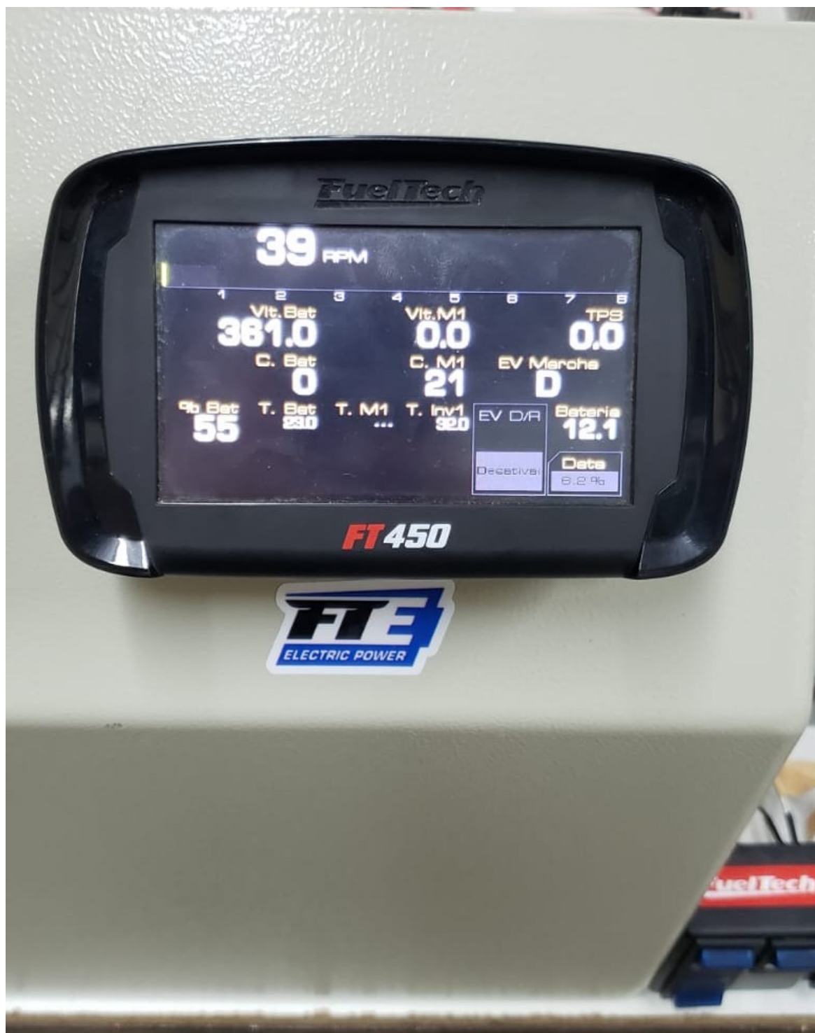
Figura 72 – Montagem da VCU em bancada.
