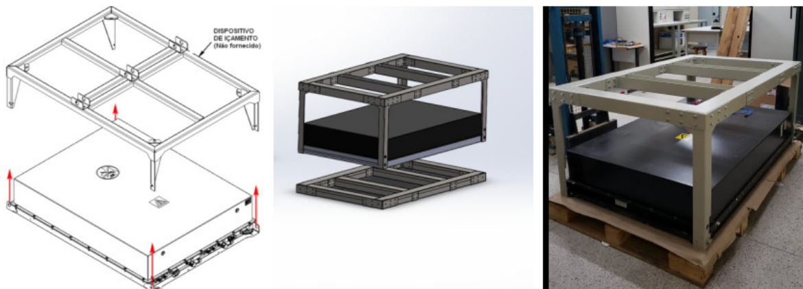
Figura 17 – Estrutura da bancada e içamento para o pack de baterias.
