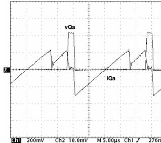
Figura 17 - Tensão (100V/div) e corrente (5A/div) em  $Q_a$
