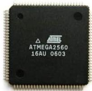
Figura 9- Microcontrolador Atmel2560 utilizado na placa do Arduino Mega2560
