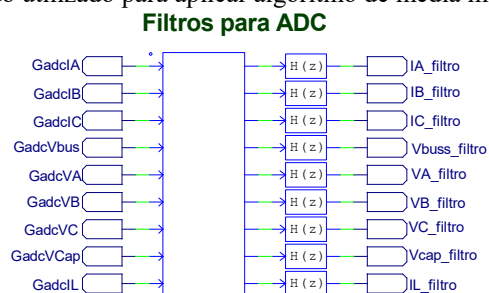
Figura A.8 - Bloco C simplificado utilizado para aplicar algoritmo de média móvel e filtros passa-baixas.
