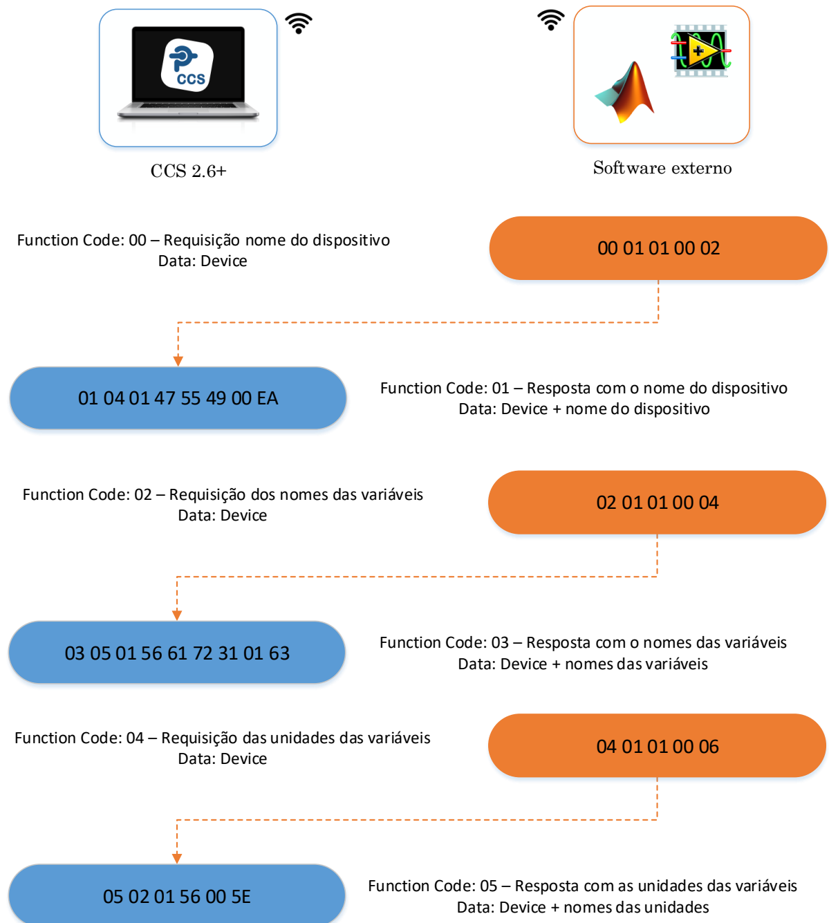
Figura 4.5 – Exemplo de mensagens enviadas entre CCS e software externo para aquisição de parâmetros.
