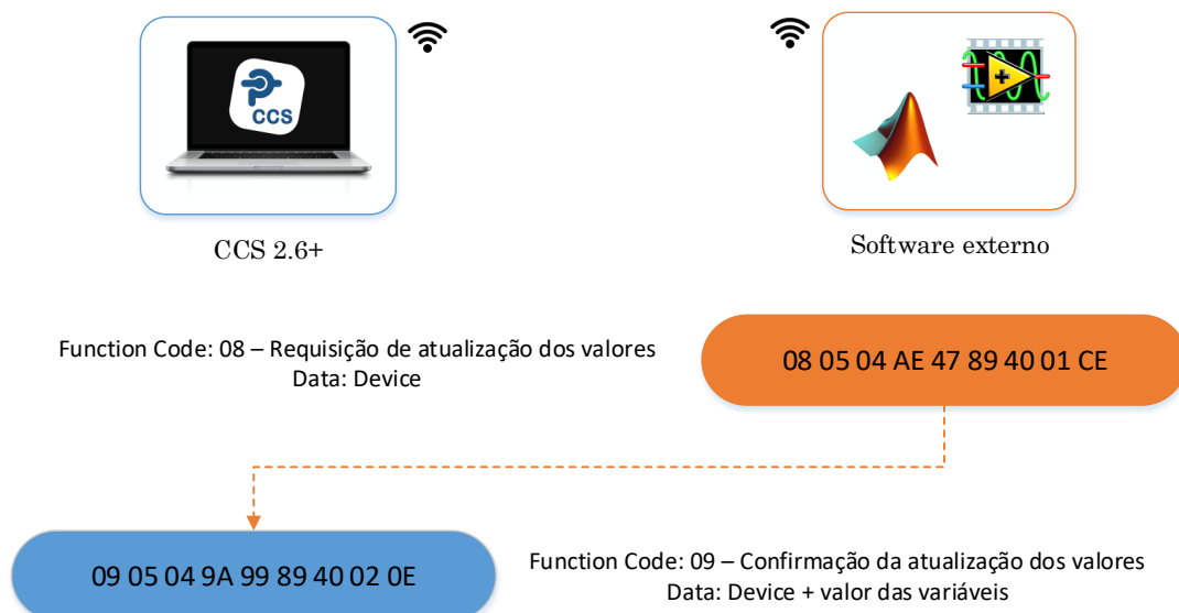
Figura 4.7 – Exemplo de mensagens enviadas entre software criado (CCS) e software externo solicitando atualização dos valores das variáveis.
