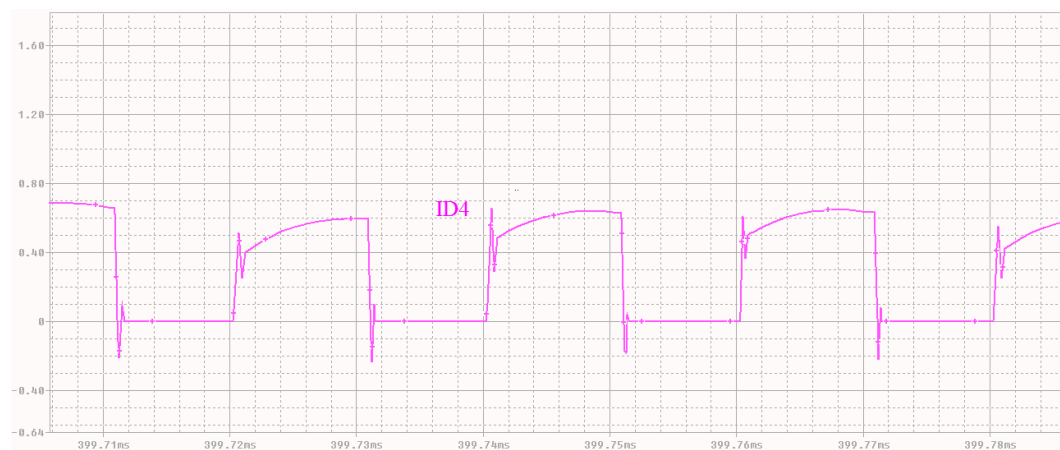
(b) Corrente no diodo D_4 .
