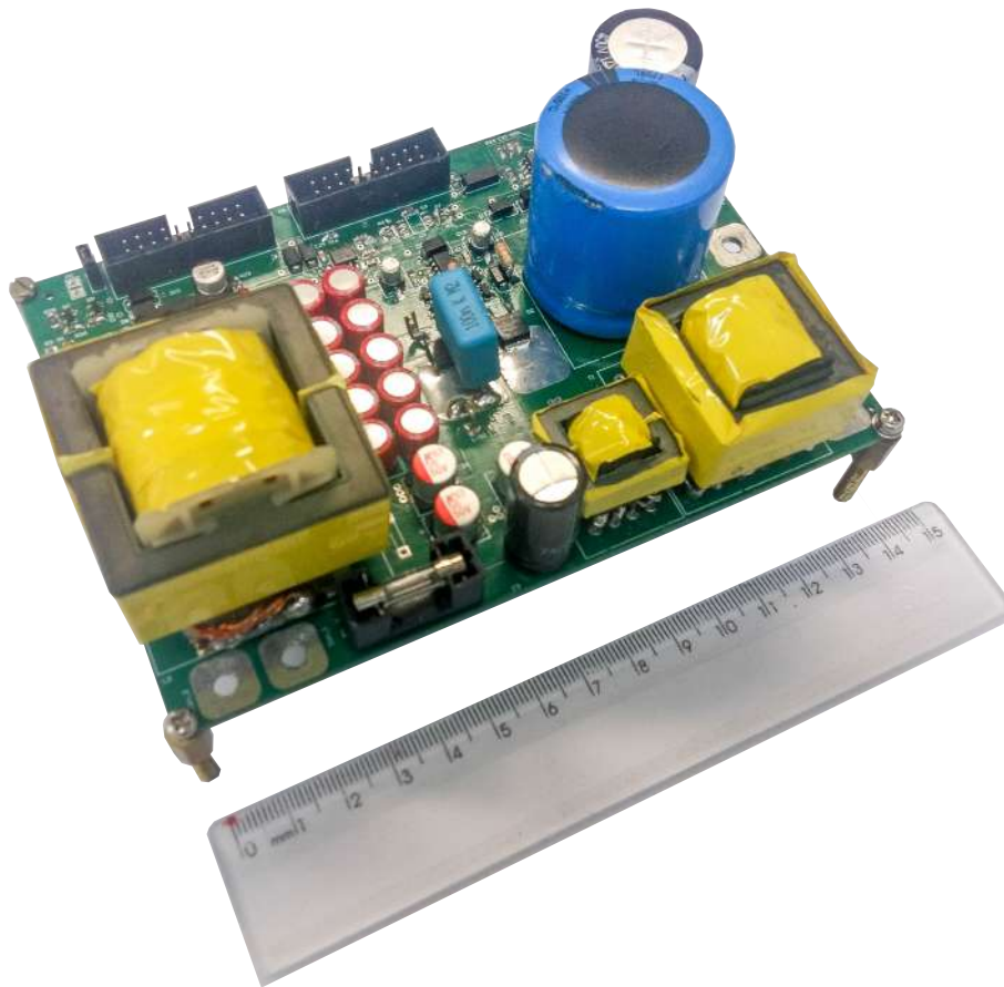
Figura 63 – Protótipo construído. Placa de potência e condicionamento de sinal. Dimensões: 14x10x4,6 cm.
