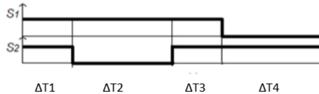
Figura 31 - Sinais de comando nas chaves
