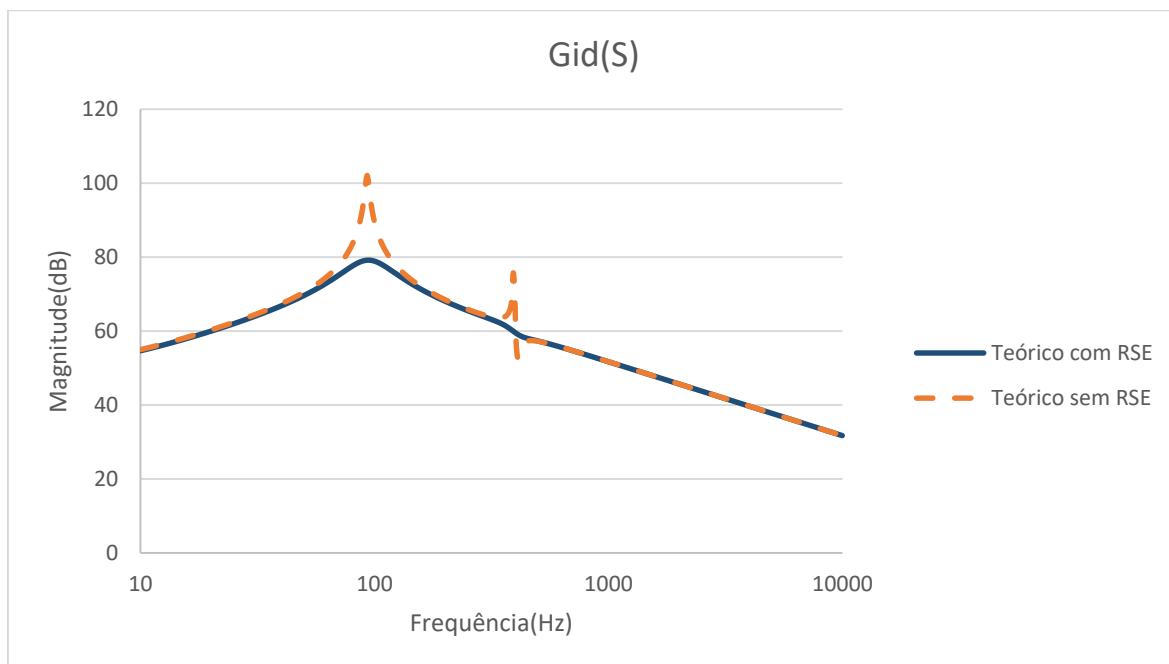
Figura 25 - Gráfico de bode da magnitude de G_{id}(s) com e sem RSE
