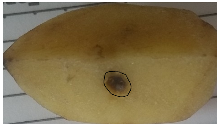
Figura 60 – Resultado prático da aplicação do protocolo com dez pulsos de 500 V, 500 \mu s e 440 Hz
