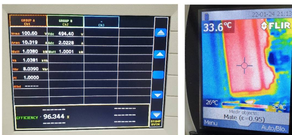
Figura 48 – Potências de entrada e saída e rendimento para operação em carga nominal com frequência de comutação de 50kHz. Temperatura do dissipador A durante a operação.
