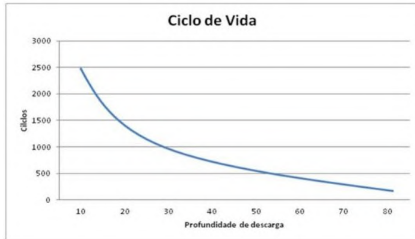
Figura 15 – Ciclos de vida da bateria chumbo-ácida vs profundidade de descarga.
