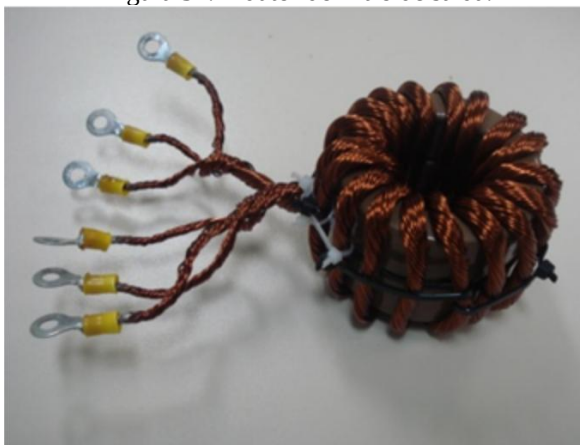
Figura 34: Indutor do filtro de saída.
