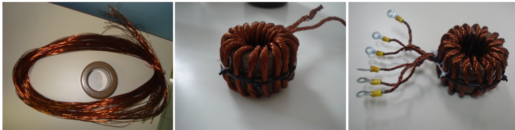
Figura 4.5: Construção do Indutor
