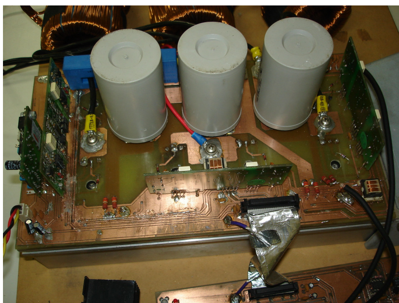
Figura 67 – Detalhe da placa de potência do conversor
