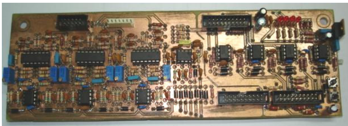
Figura 65 – Placa de condicionamento de sinais.
