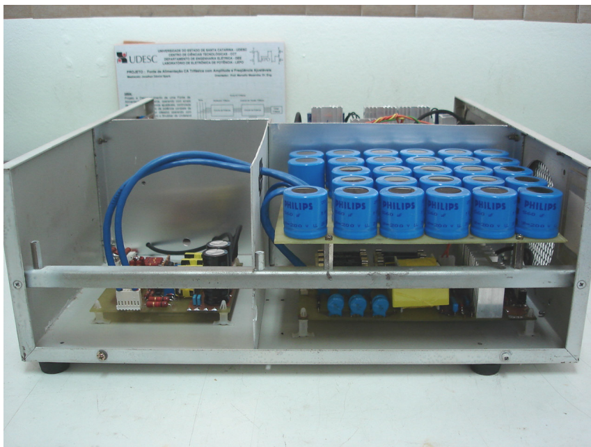
Figura 107 – Conexão da fonte de Alta-Tensão ao Pulsador.
