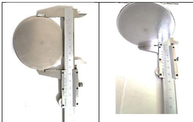
Figura 69 – Eletrodo de aço inoxidável AISI 304, usado em testes para a produção de plasmas, neste trabalho. (área total do eletrodo: 100\text{cm}^2 ).
