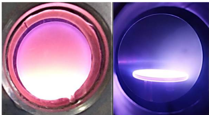
Figura 76 – Ilustração da possibilidade de espalhamento ou adesão do plasma ao eletrodo com ajuste da pressão
