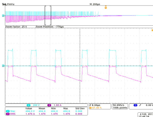
Figura 59 – Tensão dreno-source no interruptor Q_2 (em azul claro), corrente no interruptor Q_2 (em rosa)
