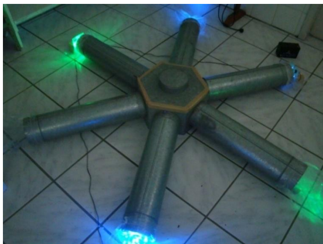
Figura 3.18 - Aparelho para teste do fototropismo em insetos
