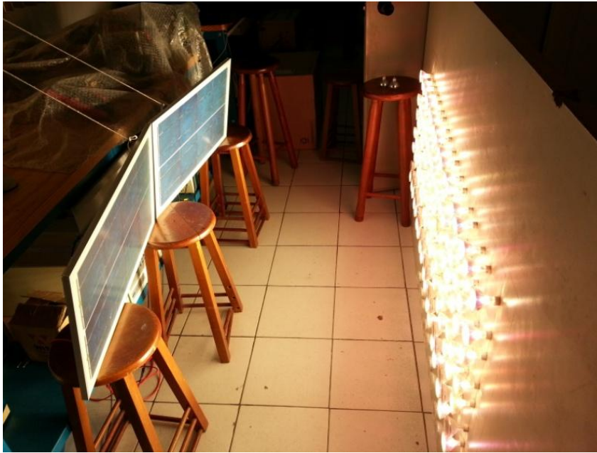
Figura 6.41 – “Sol artificial” utilizado para validação do protótipo em laboratório
