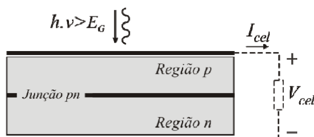
Figura 5.2 – Célula fotovoltaica do ponto de vista físico
