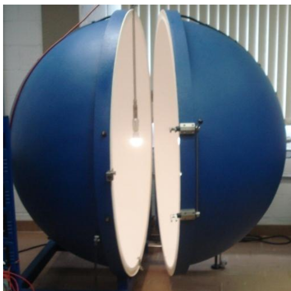
Figura 3.10 - Esfera de integração do Centro de Pesquisas de Energia Elétrica - CEPEL
