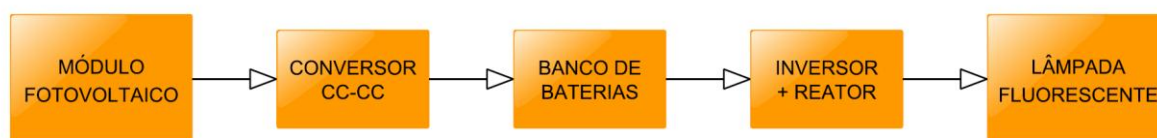
Figura 1.1 - Diagrama de blocos do sistema elétrico antigo
