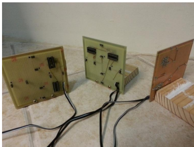
Figura 3.19 - Suporte para os LEDs do experimento
