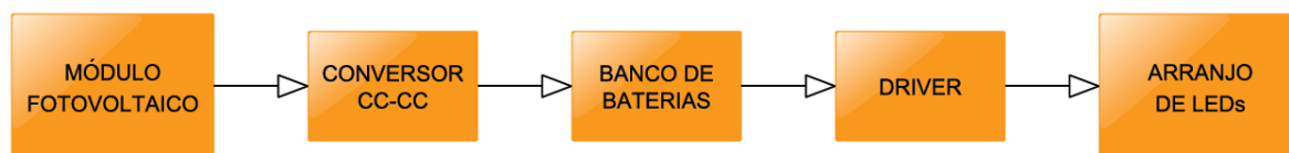
Figura 1.2 - Diagrama de blocos do sistema elétrico
