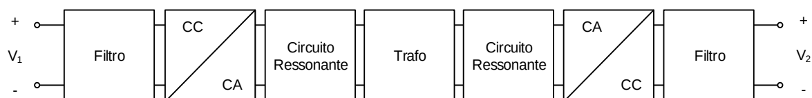
Figura 15 – Componentes de um conversor isolado CC-CC reversível
