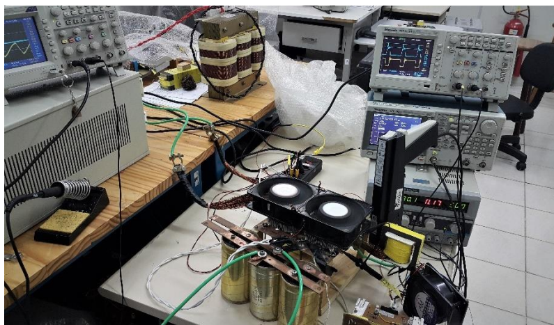
Figura 6.15 – Foto do setup de ensaio do conversor no modo elevador
