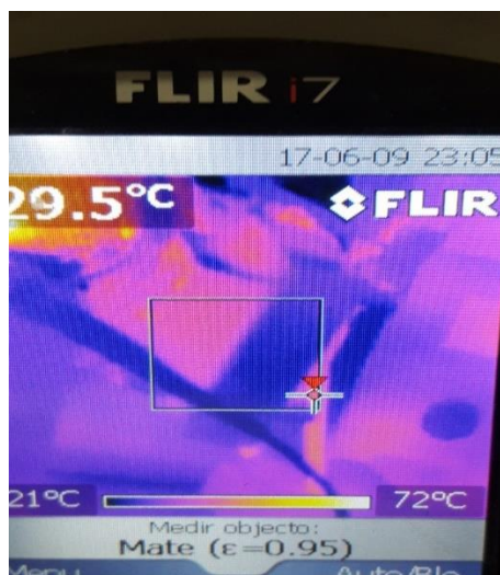
Figura 6.5 – Tensões nominais: Imagem térmica indutor L1
